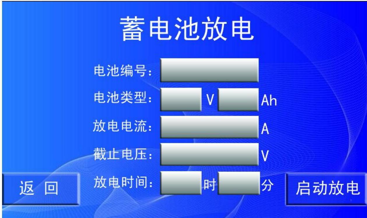
图 8. 电池放电设置界面
