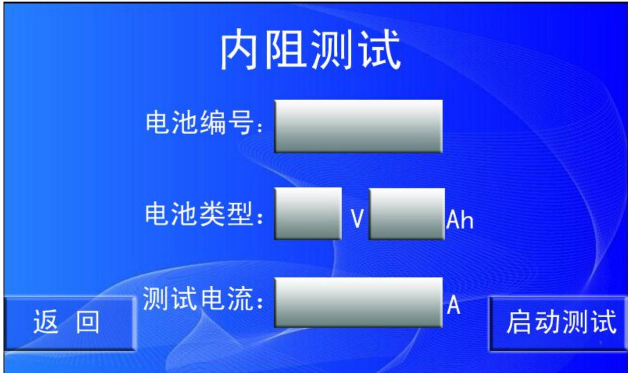
图 12. 电池内阻测试参数设置界面
