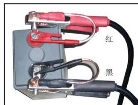
图 3. 夹具与蓄电池连接图
